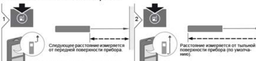
Следующее расстояние измеряется от передней поверхности прибора.
