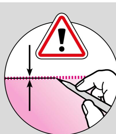
При маркировке и выравнивании всегда работайте по центру лазерной линии!
